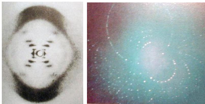
Abb.12: Laue-Aufnahmen der DNA (links erste, historische Aufnahme mit Röntgenstrahlen; rechts moderne Aufnahme mit Synchrotronstrahlung)
