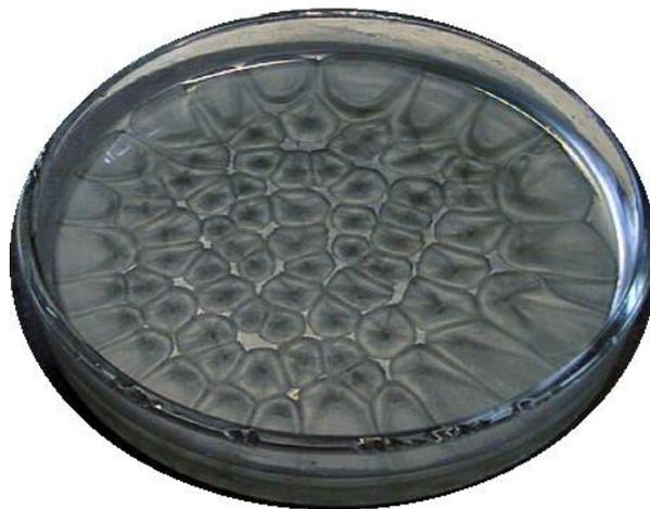
Abb. 7: Das hydrodynamische System „Benardzellen“ fern vom thermodynamischen Gleichgewicht: Ölschicht (4 mm Speiseöl) + feinstes Aluminiumpulver in 12 cm Petrischale in einem Temperaturgradienten (Unterseite aufgeheizt auf ca. 80 °C, Oberseite hat Raumtemperatur 22 °C)
